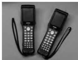
ハンディターミナルという機器を使用してICタグやバーコードを読み取ります。読み忘れないように、棚の端から端まで、かなり根気のいる作業です...
